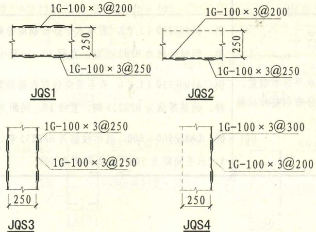
图 5.3.2-1 (b) 粘钢加固墙身水平截面示意图
