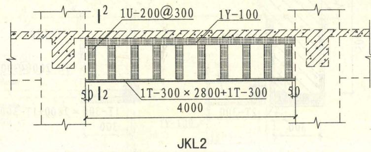
图 3.2.2 (b) 碳纤维加固梁底示意图
