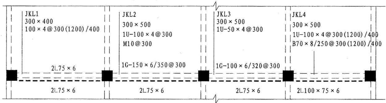
图 3.2.5 (a) 平面注写方法示例
