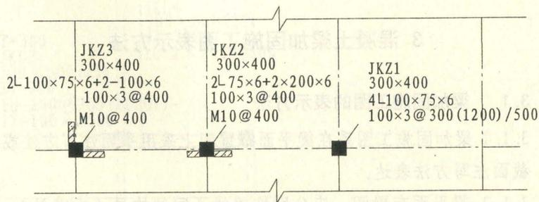
图 2.4.4 外包钢加固柱平面注写方法示例
