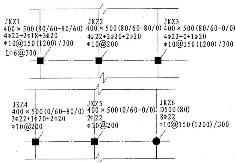
图 2.4.3 加大截面加固柱平面注写方法示例
