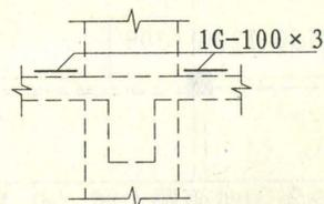
粘钢加固梁支座平面注写方法示例
