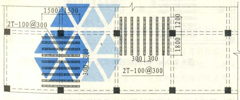
图 4.2.2 (f) 碳纤维加固板支座平面注写方法示意图
