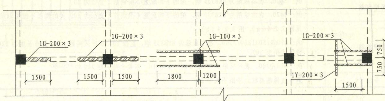
图 3.2.3 (d) 粘钢加固梁支座截面示意图
