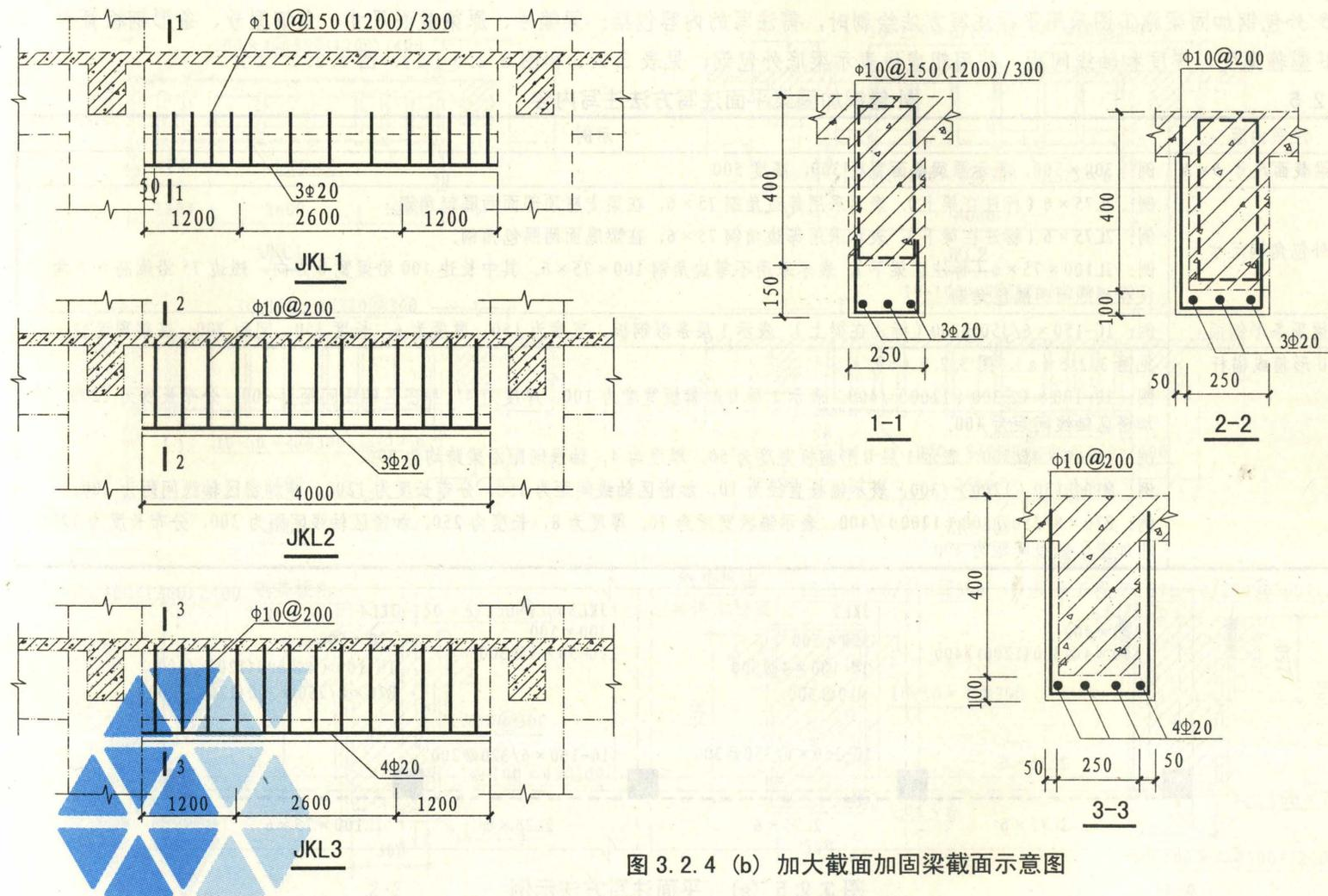
图 3.2.4 (b) 加大截面加固梁截面示意图
