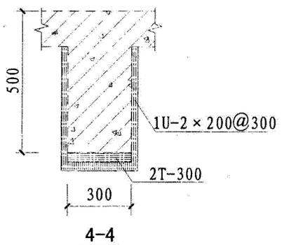
续图 3.2.2 (b) 碳纤维加固梁底示意图
