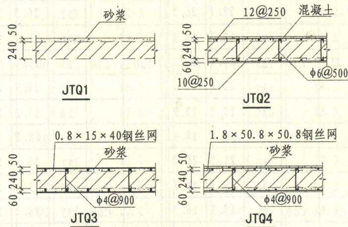
图 8.3.2 (b) 加大截面加固砌体墙身截面示意图
