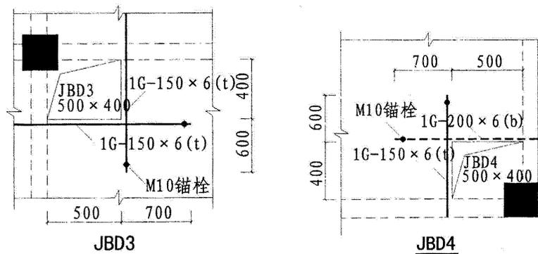
图 4.2.5 碳纤维加固楼板洞口平面注写方法示例
