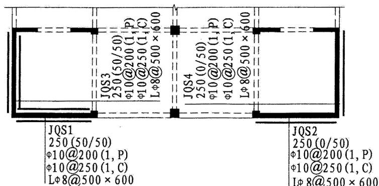
图 5.3.2-2 (a) 加大截面加固墙身平面注写方法示例
