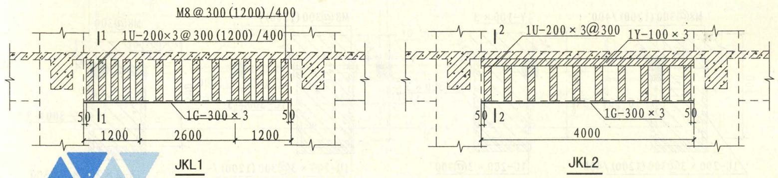
图 3.2.3 (b) 粘钢加固梁底截面示意图
